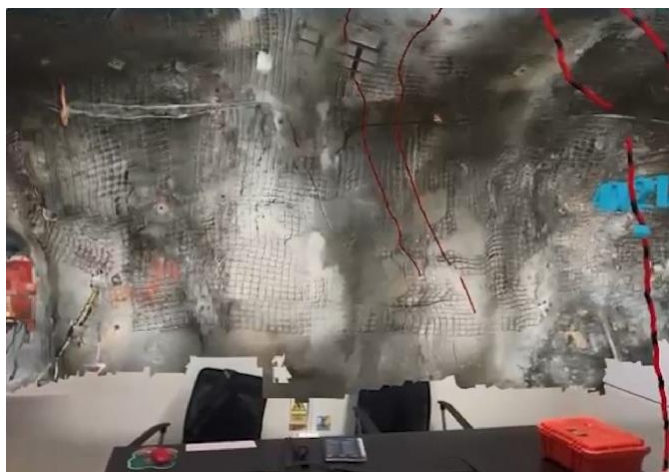
Figura 7. Realidad aumentada de una galería. La galería es observada en una oficina gracias al escaneo 3D LiDAR.
